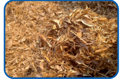
SOYABEAN HUSK (KUTAR) GROSS CALORIFIC VALUE (GCV) Kcal/kg: 3600-3800
